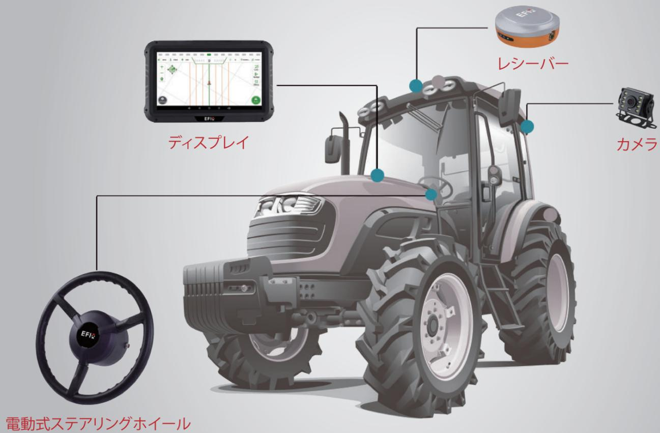
eSteer 10システムには、4Gモジュール、IMUセンサー、およびGNSSモジュールを統合したレシーバーが搭載されており、これにより車両間での載せ替えが容易になっています。
